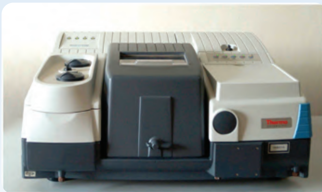
รูปที่ 3 เครื่องมือวิเคราะห์ FTIR Spectrometer และ Raman Spectroscopy
