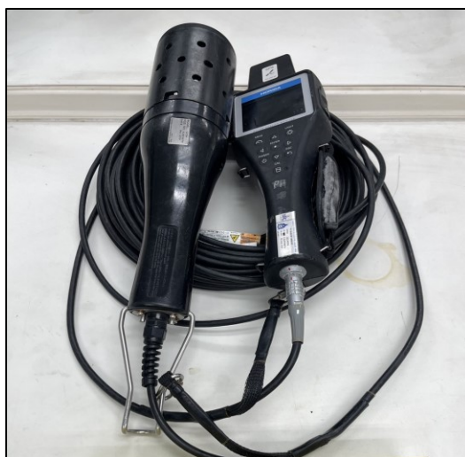
รูปที่ ๔ เครื่องวัดคุณภาพน้ำหลายตัวแปร
