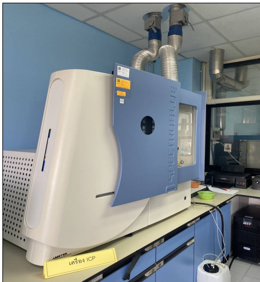
รูปที่ ๑๒ เครื่องวิเคราะห์ปริมาณธาตุในสารละลาย (Inductively Coupled Plasma Atomic Emission Spectrophotometer, ICP-AES)
