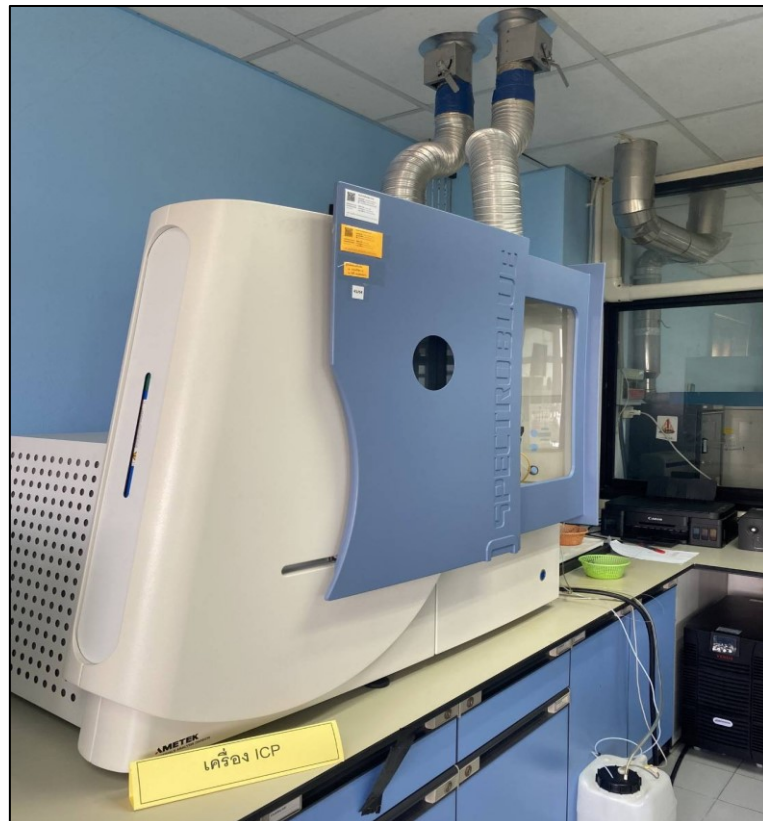
รูปที่ 12 เครื่องวิเคราะห์ปริมาณธาตุในสารละลาย (Inductively Coupled Plasma Atomic Emission Spectrophotometer, ICP-AES)
