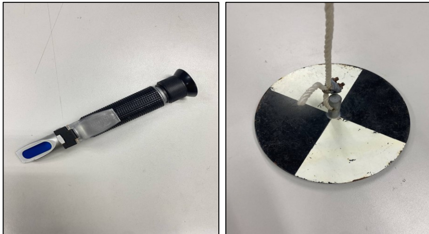
รูปที่ 13 ซ้าย เครื่องวัดค่าความเค็มในน้ำทะเล (Refractometer, Salt meter) ขวา อุปกรณ์วัดค่าความโปร่งแสงของน้ำทะเล (Sacchi disc)
