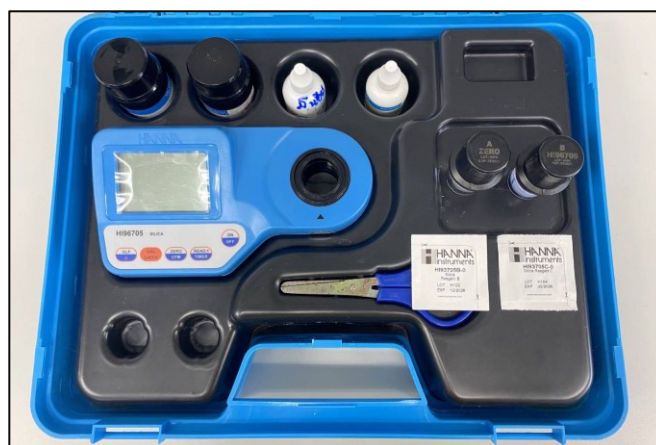
รูปที่ 15 เครื่องวิเคราะห์ปริมาณซิลิกา ( \text{SiO}_2 ) ในน้ำทะเล
